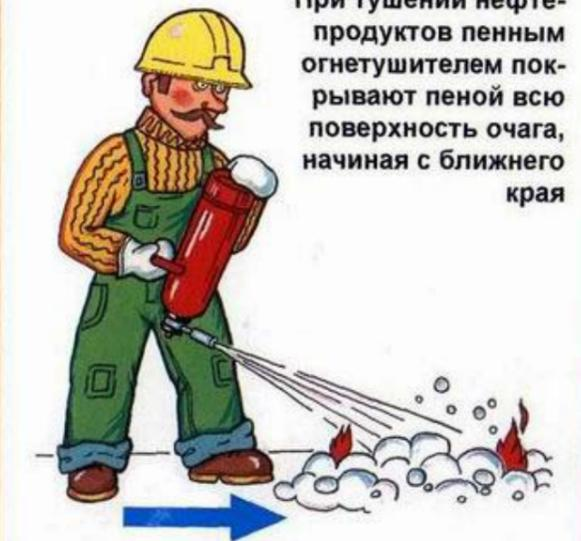
При тушении нефтепродуктов пенным огнетушителем покрывают пеной всю поверхность очага, начиная с ближнего края
